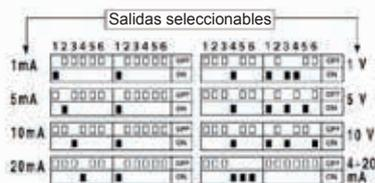
Cuando se requiere una salida de voltaje, la conexión es por los terminales 13 y 14 para la salida de corriente, conectar a los terminales 17 y 18.
