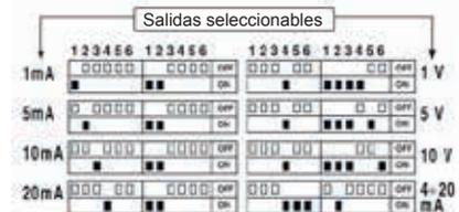
Cuando se requiere una salida de voltaje, la conexión es por los terminales 13 y 14 para la salida de corriente, conectar a los terminales 17 y 18.
