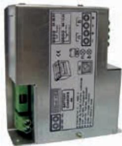
**1RAL800 y RAL800V**, suministros estabilizados y cargadores de baterías con tecnología de conmutación, ahorro de energía energética. Frecuencia fija de la conmutación; corriente de arranque baja; protección de la sobreintensidad de corriente de la tensión y de la sobretensión; parada de trabajo con la tensión más baja que 180V; reinicio automático cuando se cancelan las condiciones de parada; pulso por la limitación de la corriente del pulso; FET interno del sentido del alto voltaje.
