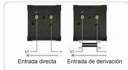
**ERF48 - ERF72 - ERF96 - Medidor de frecuencia con placa escala a 90°**
