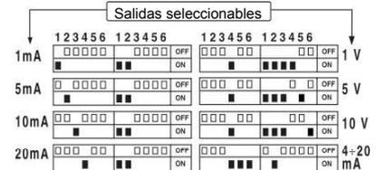
Cuando se requiere una salida de voltaje, la conexión es por los terminales 13 y 14 para la salida de corriente, conectar a los terminales 17 y 18.
